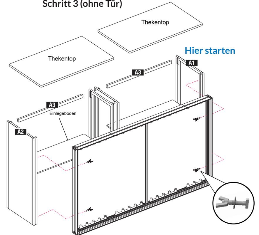
Schieben Sie die T-Schraube durch den Brightwall-Rahmen und setzen Sie Flügelmutter und Unterlegscheibe auf der Innenseite des Rahmens ein. Setzen Sie das „t“ in den Kanal A1 und drehen Sie die Schraube zum Einrasten.
